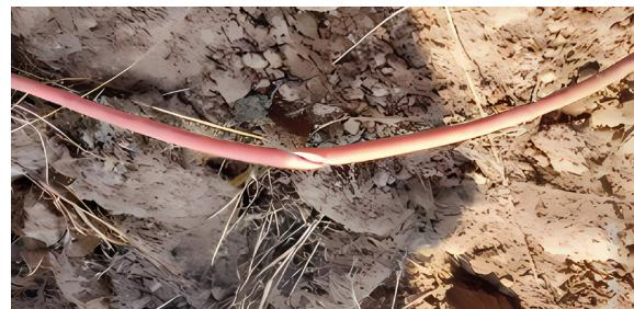
**2. Factores Ambientales:** La lluvia, la humedad y la acumulación de polvo aceleran la degradación del aislamiento, particularmente en regiones con condiciones climáticas adversas.
