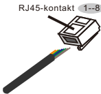
Bild 4.36 Avlägsna isoleringsskiktet och anslut till RJ45-kontakten
