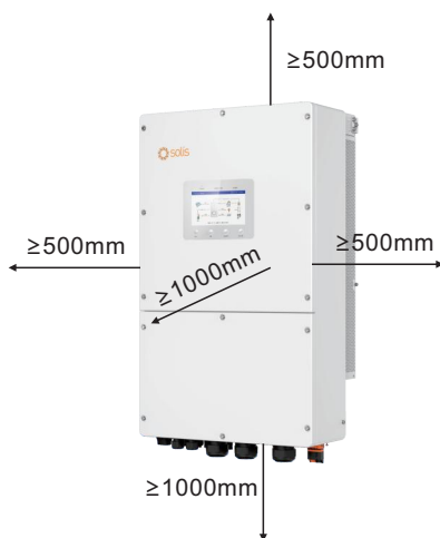
Figura 3.5 Spații libere pentru montarea inverterului
